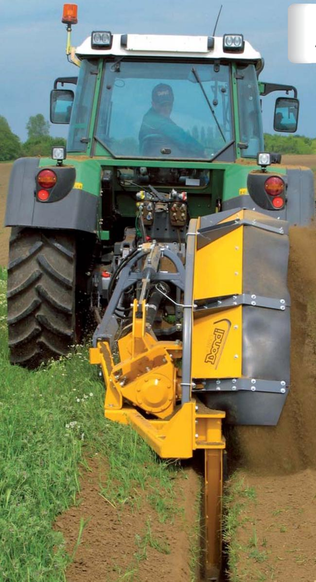
DONDIDRENAG, è efficace su qualsiasi natura di terreno, privo di sassi, per aprire dreni e per la posa in opera di tubi di drenaggio, irrigazione, cavi elettrici, telefonici, tubi per acquedotti con un diametro massimo di 150 mm. DONDIDRENAG è utilizzato sull'attacco a 3° punto di qualsiasi tipo di trattore a ruote provvisto di marce rampanti a 0,35 / 0,65 Km/h ed azionato dalla presa di forza a 540 e 1000 Giri/minuto.
